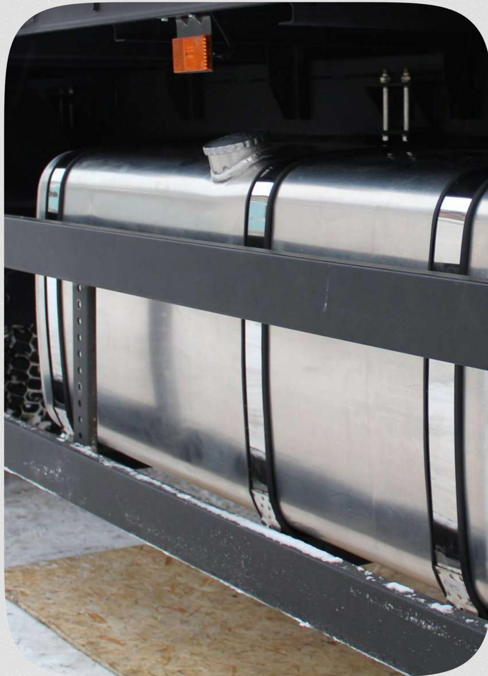
*Топливный бак 600 литров на Камаз Т2640*
