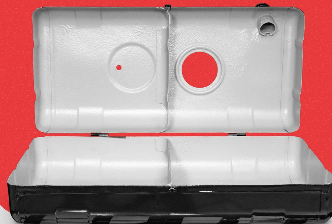
Топливный бак Газель в разрезе
